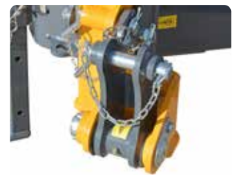
Dispositivo ammortizzatore meccanico (salvaguardia in caso di ostacoli). Mechanical shock absorber device (protection in case of obstacles).
