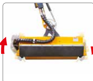
Sistema Floating autolivellante al terreno della testata trinciante. Floating head system to follow ground contours.
