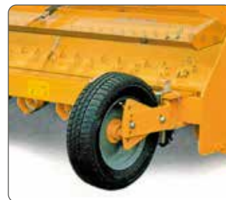
Ruote in gomma sterzanti e regolabili in altezza. Height adjustable rubber steered wheels.
