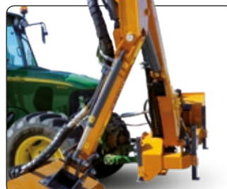
Dispositivo di sicurezza secondo braccio. Hydraulic breakaway on second arm with accumulator controlled autoreset facility.
