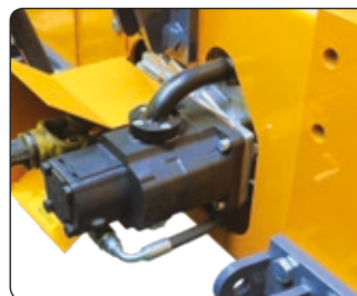
Pompa in ghisa ad ingranaggi. Gear pump.
