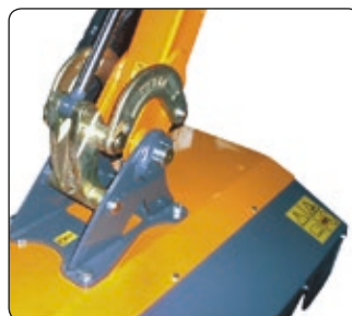
Angolazione testata 190°. Flailhead angle 190°.
