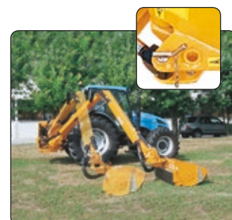
Predisposizione per posizione arretrata. Prepared beforehand to work in the classic rear position.
