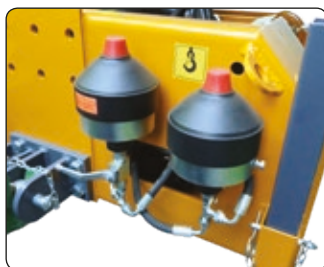
Accumulatori di azoto. Lift float nitrogen accumulator.
