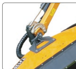
Angolazione testata 235° (opt.). Flailhead angle 235° option.
