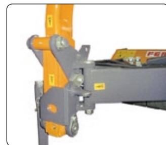
Ammortizzatore meccanico. Salvaguardia in caso di ostacolo. Mechanical protection in the event of obstacles.
