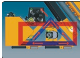
Telaio DELTA BOX con forze distribuite compensate. Delta Box" frame with compensated distributed forces.
