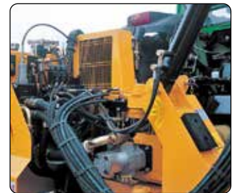
Scambiatore di calore con termostato. Oil cooler with thermostat
