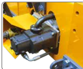
Pompa in ghisa ad ingranaggi. Gear pump.
