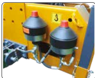
Accumulatori di azoto. Lift float nitrogen accumulator.
