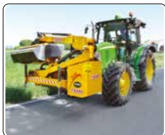
Posizione trasferimento su strada. Road transport position.
