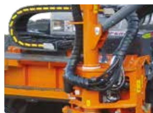
Torretta girevole porta-braccio. Rotating arm-support turret.
