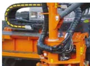
Torretta girevole porta-braccio. Rotating arm-support turret.
