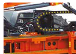
Scambiatore di calore con termostato. Oil cooler with thermostat.
