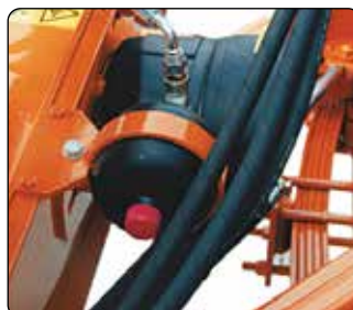
Sospensione oleopneumatica del corpo trinciante. Oleo-pneumatic suspension for cutting head.
