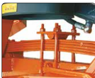
Ammortizzatore meccanico. Mechanical shock absorber.
