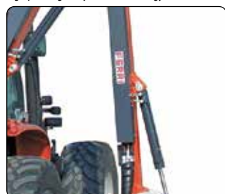
Tubazioni rigide e protette. Rigid and protected guides.
