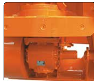
Giunto elastico tra moltiplicatore e rotore. Elastic joint between gearbox and rotor.
