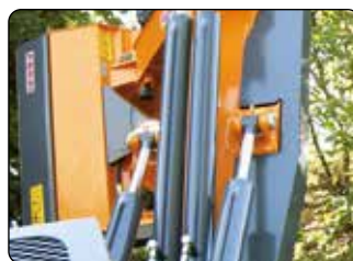
4 martinetti posizionati sul 1° braccio. 4 cylinders positioned on 1st arm.
