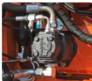
Impianto idraulico ad ingranaggi in circuito aperto. High Power Gear hydraulic system.
