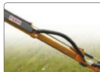
Braccio con sfilo telescopico (solo Mod. TV 62). Arm with telescopic extension (only Mod. TV 62).
