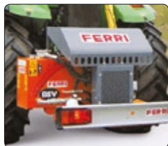
Scambiatore di calore. Oil cooler with thermostat.
