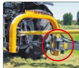
Telaio oscillante. Autolivellamento al terreno. Floating frame.
