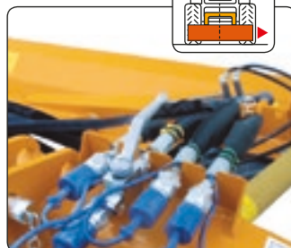
Rubinetto per il blocco idraulico in trasporto, inserimento manuale (no catene, no staffe). Manual hydraulic lock tap for transport (no chains, no brackets).
