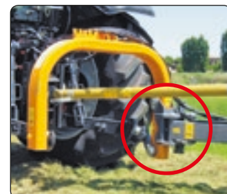
Corpo trinciante oscillante. Floating frame.
