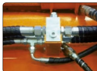
Valvola antiurto ed anti-cavitazione. Anti-shock + anti-cavitation valve.
