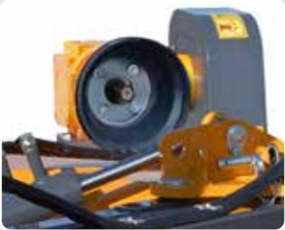
Gruppo moltiplicatore INTERNO alla trasmissione. Gearbox internal to the drive housing.
