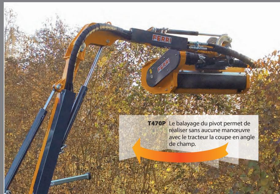
**T470P** Le balayage du pivot permet de réaliser sans aucune manœuvre avec le tracteur la coupe en angle de champ.
