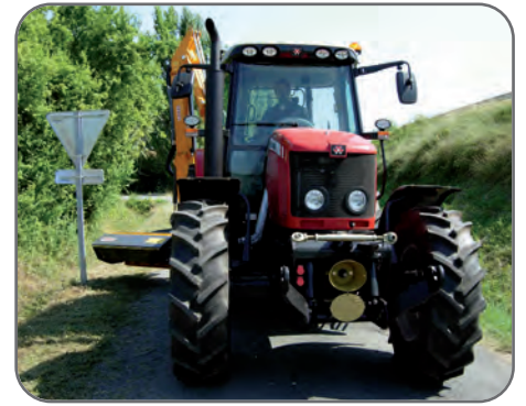
le tracteur est statique pendant que le bras nettoie autour de l'obstacle
