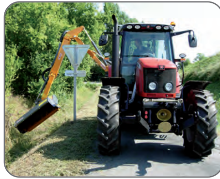
le tracteur est statique pendant que le bras nettoie autour de l'obstacle
