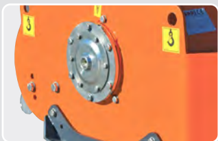
Support du rotor avec palier renforcé à l'intérieur.
