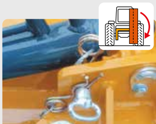
Goupille de verrouillage mécanique pendant le transport, (pas de chaînes, pas de supports).
