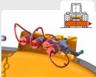
Robinet de verrouillage hydraulique pour le transport. Engagement manuel (pas de chaînes, pas de supports).
