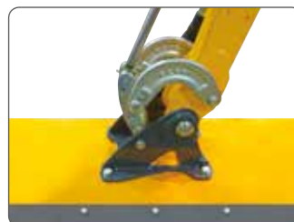
Elementi stampati per l'articolazione della testata. Drop forged flailhead linkages.
