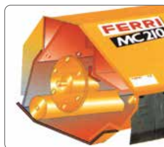
Controtelaio interno. Inner lining.
