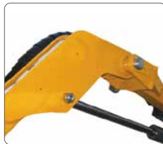
Elementi stampati per articolazione bracci. Drop forged arm brackets.
