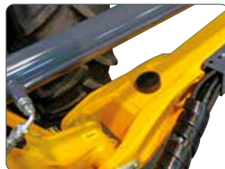
Elementi stampati per le articolazioni dei bracci. Drop forged arm brackets.
