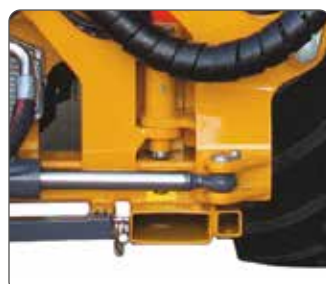
Supporto girevole scatolato. Boxed pivoting bracket.
