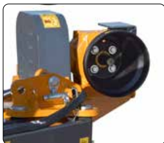
Gruppo moltiplicatore esterno alla trasmissione. Gearbox external to the drive housing.
