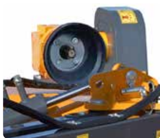
Gruppo moltiplicatore interno alla trasmissione. Gearbox internal to the drive housing.
