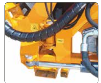
Supporto girevole scatolato. Enclosed rotating support.
