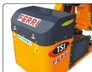
Serbatoio pressurizzato e separato dal telaio con cofanatura per la protezione dei distributori.
