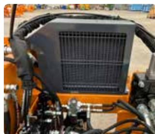
Scambiatore di calore con termostato.
