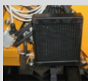
Scambiatore di calore con termostato (optional solo per TA32)
