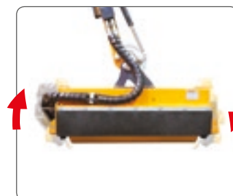
Schwimmstellung. Sistema "floating".
