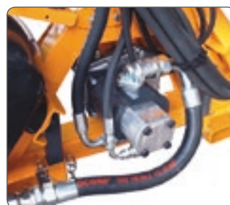
Hydraulikpumpe Auslösung Guss-Rotor Gruppe 3. Bomba hidráulica accionamiento rotor de fundición grupo 3
