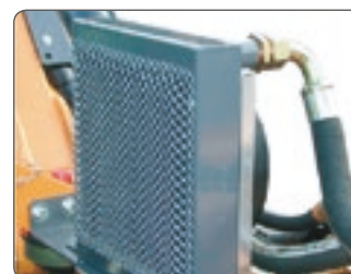
Ölkühler mit Thermostat (option). Intercambiador de calor con termostato (opcional).
