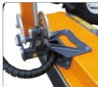
Geschmiedete Elemente für Gelenke Auslegerarme und Mähkopf. Elementos estampados para las articulaciones del cabezal.
