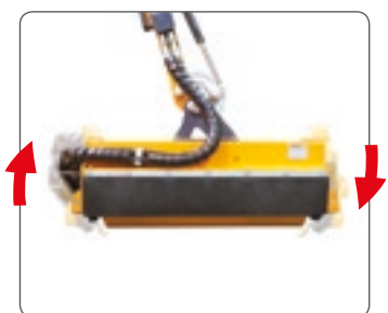
Schwimmstellung. Sistema "floating".
