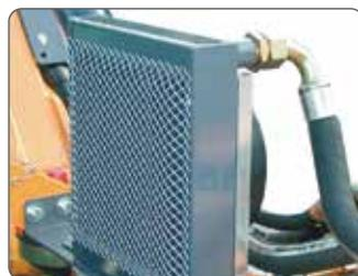
Scambiatore di calore con termostato (optional).
