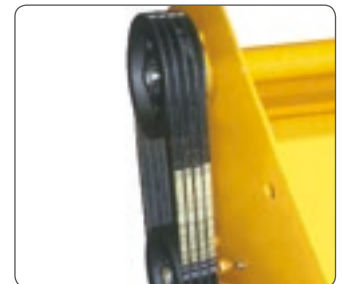
Zahnriemenantrieb (4 SPB-Riemen). Transmisión por correas dentadas (4 correas SPB).
