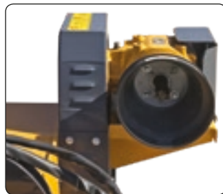
Übersetzungsgetriebe-Einheit außerhalb des Antriebs. Grupo multiplicador externo a la transmisión.
