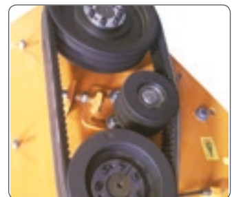
Spannungsvorrichtung mit Schraube für die Spannung der Riemen. Tensor de la correa con tornillo para el tensado de las correas.
