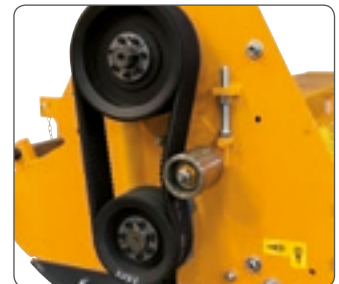
Antrieb mit Zahnriemen (4 SPB-Riemen). Transmisión por correas dentadas (4 correas SPB).
