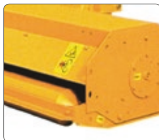
Höhenverstellbare Stützwalze. Rodillo de apoyo ajustable en altura.
