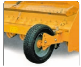
Lenkende Gummiräder, höhenverstellbar. Ruedas motrices de goma y ajustables en altura.
