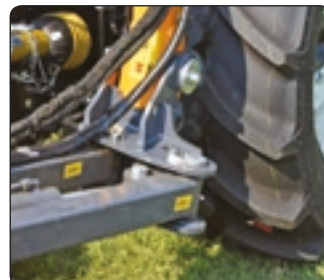
Der Zylinder für die hydraulische Bewegung ist innerhalb der Auslegerarme des Parallelogramms. El pistón para el desplazamiento hidráulico se encuentra en el interior de los brazos del paralelogramo.
