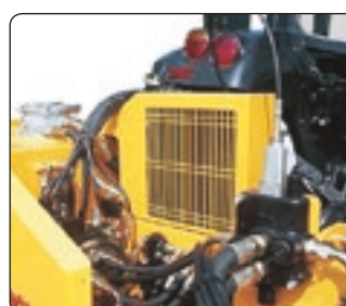
Ölkühler mit Thermostat. Intercambiador de calor con termostato.
