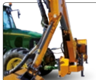
Hydraulische Sicherheitsvorrichtung zweiter Auslegerarm. Dispositivo de seguridad segundo brazo.
