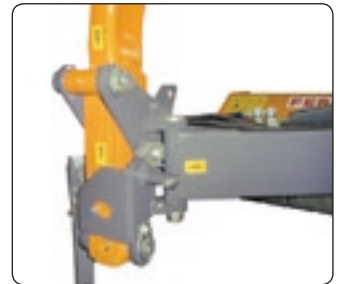
Mechanische Anfahrtsicherung. Schutz im Fall von Hindernissen. Amortiguador mecánico de muelles. Protección en caso de obstáculo.
