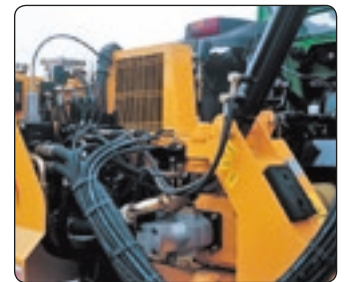
Ölkühler mit Thermostat. Intercambiador de calor con termostato.
