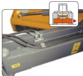
Hydraulisches Sperrventil für Transport, (keine Ketten, keine Bügel). Válvula de bloqueo hidráulico para el transporte, inserción automática (sin cadenas, sin bridas).
