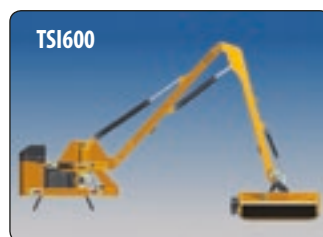
TSI600 Cinematismo bracci studiato per sfruttare al meglio l'estensione dei due bracci. Kinematics designed to make the most of the extension of the two arms.
