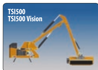
TSI500 TSI1500 Vision Cinematismo bracci progettato per lavorare in presenza di ostacoli stradali, esempio guard-rail. Kinematism arms is designed to work in the presence of road obstacles, e.g. guard rails.
