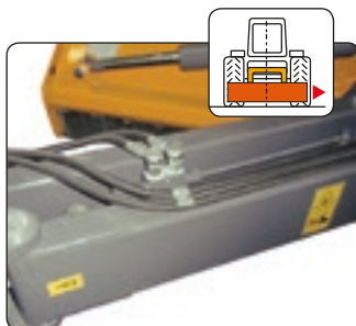
Valvola di blocco idraulico in trasporto, inserimento automatico (no catene, no staffe). Automatic hydraulic lock valve for transport (no chains, no brackets).
