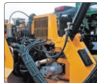
Scambiatore di calore con termostato. Oil cooler with thermostat
