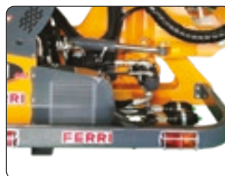
Paraurti sagomato con gruppi fanali incorporati (opt). Shaped bumper with incorporated headlamp groups (opt).
