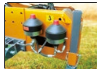
Druckgasspeichers. Acumuladores de nitrógeno.
