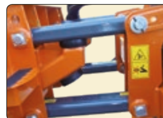
Selbstnivellierung zur Anpassung an die Unebenheiten des Geländes mit einer Auslenkung von 185 mm. Autonivelación para seguir el curso del terreno con una excursión de 185 mm 185 mm excursion.
