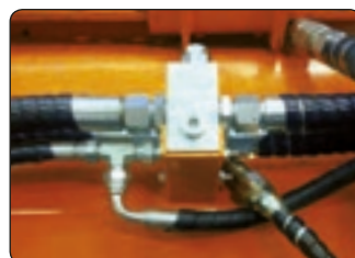
Überdruckventil. Válvula de máxima y válvula contra golpe de ariete + anticavitación.
