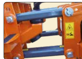
Autolivellante per seguire l'andamento del terreno con un'escursione di 185 mm. Self levelling device to follow ground contours with 185 mm excursion.
