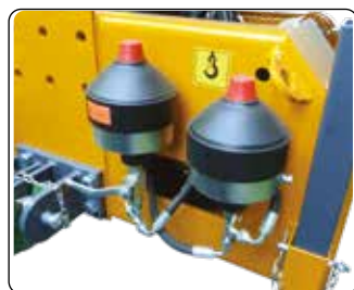
Accumulatori di azoto. Lift float nitrogen accumulator.
