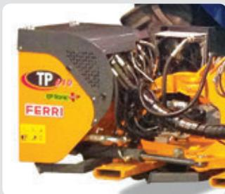
Nuovo design serbatoio pressurizzato e separato dal telaio con carter di protezione del distributore incernierato (EP-Tronic) - New design Bolt on and pressurized oil tank with hinged cover to protect the hydraulic distributor (EP-Tronic).
