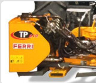
Nuovo design serbatoio pressurizzato e separato dal telaio (Classic) - New design Bolt on and pressurized oil tank. (Classic)
