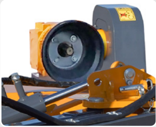
Übersetzungsgetriebe-Einheit innerhalb des Antriebs Grupo multiplicador INTERNO a la transmisión.
