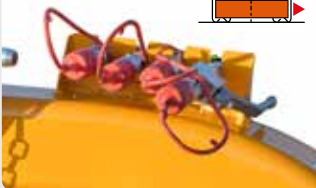
Hahn für die Hydraulikssperre beim Transport, manuell einzulegen (Keine Ketten, keine Bügel) Llave de bloqueo hidráulico para el transporte (sin cadenas ni bridas).
