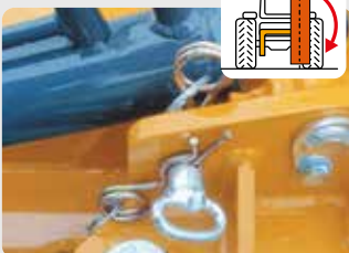
Stift als mechanische Sperre beim Transport, (Keine Ketten, keine Bügel). Perno de bloqueo mecánico para el transporte.
